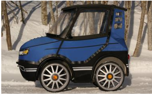
Figur 3-9 "PodRide" är en fyrhjulig cykel med heltäckande kaross som har utvecklats i Sverige ( http://www.jmk-innovation.se/nyheter/ )
