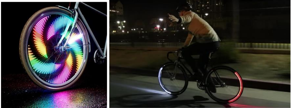
Figur 3-5 Lateral cykelbelysning som ökar visibilitet för cyklister vid korsningar och utfarten (vänsterbild: http://www.monkeylectric.com/ och högerbild: https://www.engadget.com/2015/10/23/revo-lights-eclipse-bike-lights/ )
