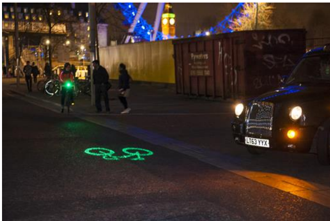
Figur 3-6 Blazes laserbelysning som visar en cykelsymbol på marken innan cyklister kommer (Källa: https://www.bikecitizens.net/product-test-blaze-laserlight/ )
